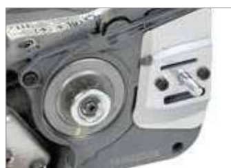
Сцепление "OnBoard": быстрая установка режущего элемента, меньшая степень загрязнения муфты сцепления, что обеспечивает неизменные с течением времени характеристики.
