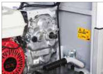
Независимый отбор мощности при 2100 об/мин.
