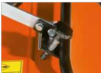
Пружина для регулировки глубины обработки. Обеспечивает поддержание заданного положения.
