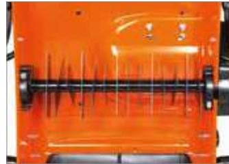
Ротор, состоящий из 15 стационарных ножей.
