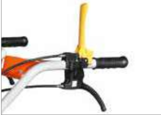
Рычаг на руле для переключения передач.
