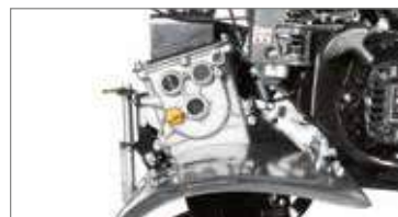
Трансмиссия с зубчатыми колесами, погруженными в масляную ванну, нуждающаяся лишь в незначительном техобслуживании.
