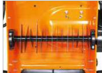
Ротор, состоящий из 15 стационарных ножей.
