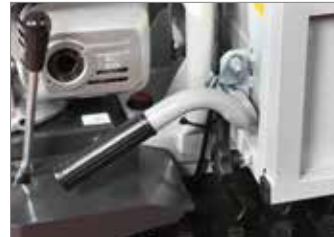
Ручное опрокидывание с автоматической системой блокировки.
