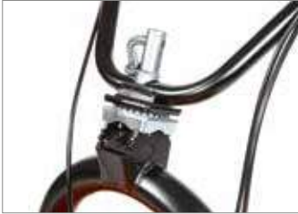
Руль регулируется по вертикали и горизонтали с помощью расположенного на нем соответствующего рычага.
